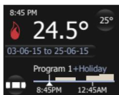
Na zaslonu vidimo da so počitnice planirane od 3.6. 2015 do 25.6. 2015, SENZ se bo po preteku tega obdobja vrnil na Program 1. S pritiskom na gumb lahko prilagodimo urnik.
