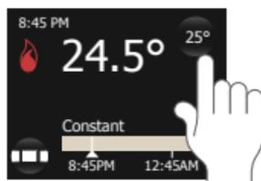
V tem načinu se temperatura spreminja s pritiskom na gumb z željeno temperaturo.
