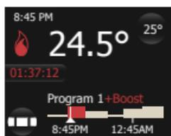
Na domačem zaslonu se trajanje funkcije odšteva. Dodatno sta potek in temperatura vidna v časovnici na zaslonu.
